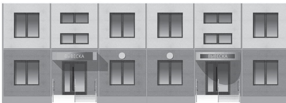
ПЛОХО. У вывесок, расположенных на козырьках здания, имеются подложки
