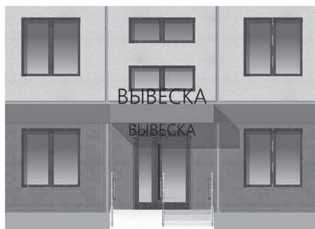
ПЛОХО. Вывеска расположена под или над козырьком
