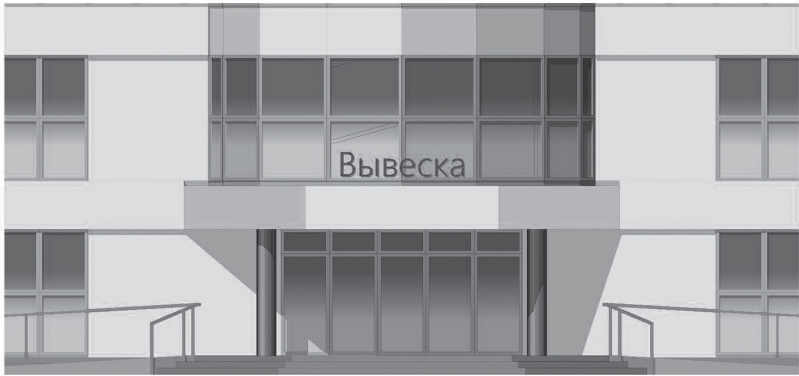
ПЛОХО. Вывеска расположена над козырьком и загроживает окна
