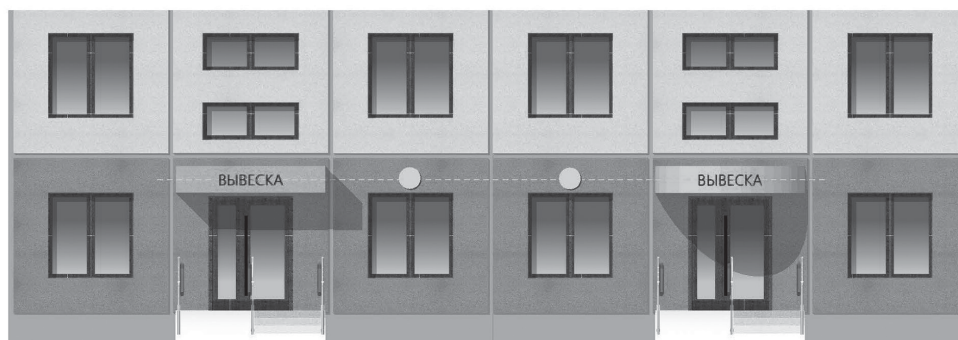
ХОРОШО. Вывески, расположенные на козырьках одного здания, имеют общую горизонтальную ось
