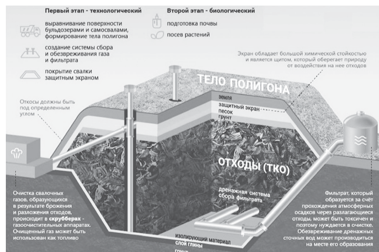
▶ Схема строения террикона на рекультивированной свалке
